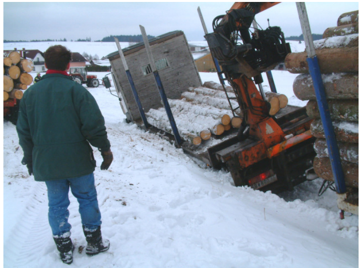
Schwierig gestaltete sich die Bergung eines mit Holz beladenen LKW. Das gesamte Ladegut musste auf Rückewagen umgeladen werden, bevor man mit der eigentlichen Bergung beginnen konnte.
